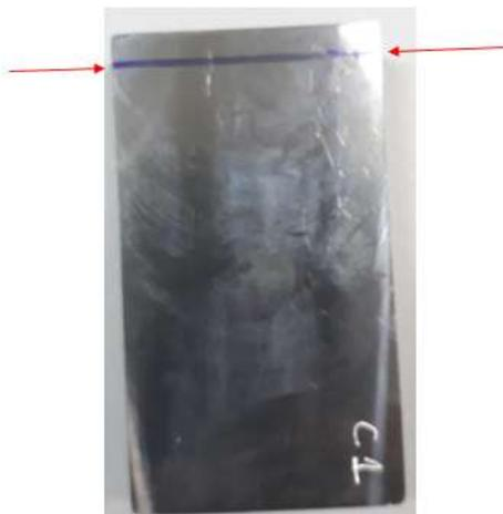
**Figura 3.10:** Marcação do corte inicial de preparação das amostras para o ensaio de microdureza em profundidade
