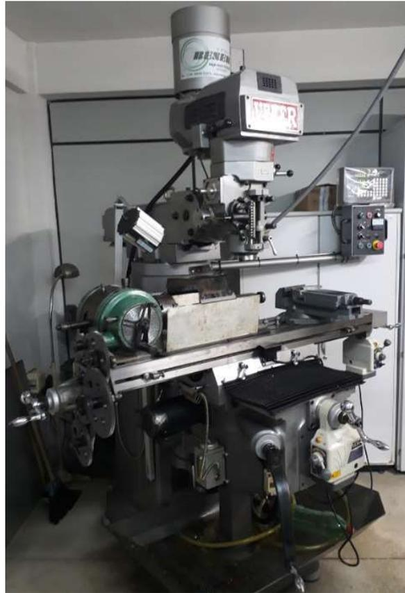
**Figura 3.5:** Fresadora Ferramenteira VEKER, modelo 420i
