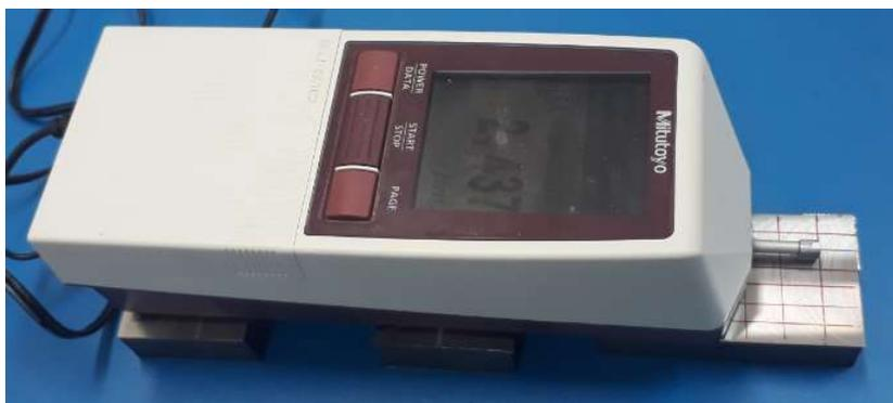
**Figura 3.8:** Rugosímetro portátil *Mitutoyo*
